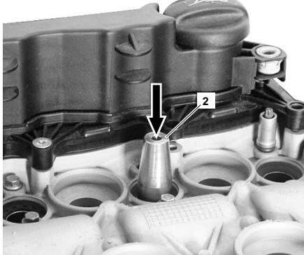
Placer le joint d'étanchéité.
