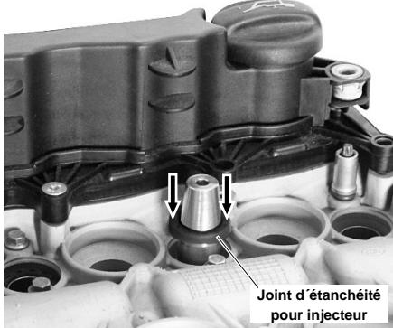
Insérer par pression le joint d'étanchéité.
