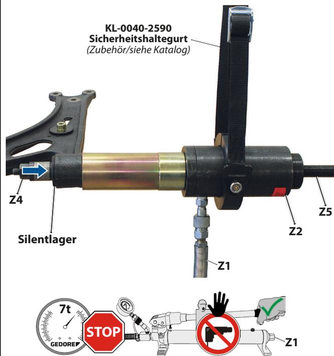
📷6: Silentlager- und -Werkzeug am Querlenker ansetzen.
