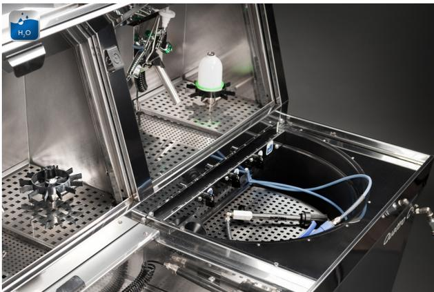
Die Reinigungsbürste und -pistole spült mit Leitungswasser\* oder recyceltem Wasser. Durch Koagulation werden Lackrückstände getrennt und getrocknet zur Vereinfachung der Abfallbehandlung.
