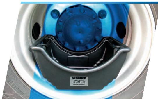
Universell passend für NKW-Steckachsen, z.B. Mercedes, MAN, Volvo, DAF, Scania, etc.
