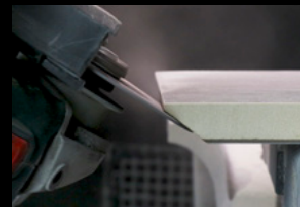
... et chanfreinage de carrelages avec un seul disque et sans changement d'outil.
