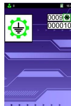
Verwenden Sie die Tasten ▲ oder ▼, um den Generatortyp auszuwählen, und drücken Sie dann die Eingabetaste [↵], um den Counter auf null zurückzusetzen.
