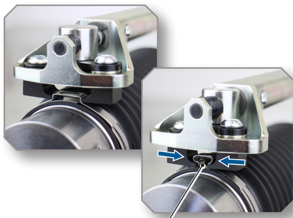
Spannmaß der Ohrschlauchschele grundsätzlich nach Herstellervorgaben!
