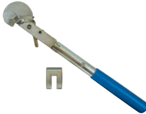
Universell passend für PKW-Spurstangen mit Rohr-Ø 11 - 23 mm.
