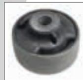
Passend für die hinteren Silentlager (Gummimetalllager) am Vorderachs-Querlenker bei VW, Audi, Seat, Škoda und Cupra.
