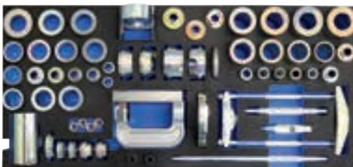
Utilisation universelle pour la réparation de roulements de roue, de systèmes de direction et d'essieu des voitures et des camionnettes. Le poste de travail mobile idéal pour les travaux de remise en état rapides et bien organisés.
