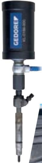
Universellement adapté aux injecteurs diesel BOSCH et DELPHI avec filetage intérieur M17x1 et filetage extérieur M14x1,5, par exemple chez PSA, Fiat, Mercedes, VW-Audi, Renault, Nissan, Opel, Toyota, etc.
