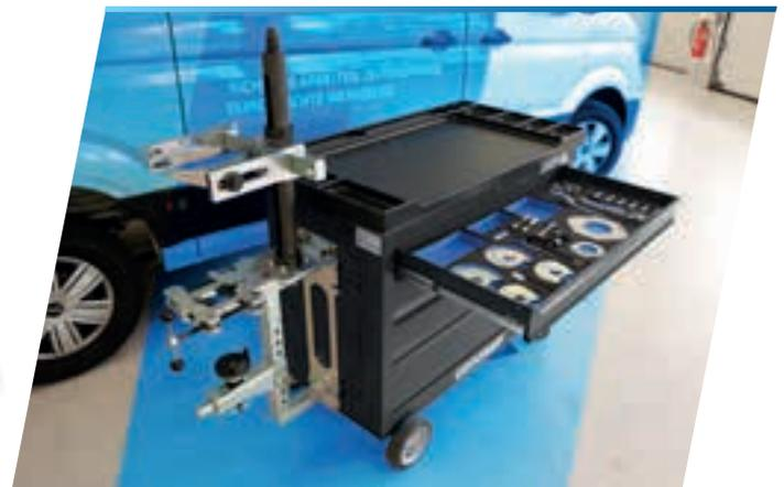
Utilisation universelle sur les systèmes de châssis des voitures particulières et des camionnettes. Poste de travail mobile avec vaste assortiment d'outils spéciaux pour des travaux de maintenance rapides et efficaces, particulièrement en ce qui concerne le remplacement des ressorts et des amortisseurs.
