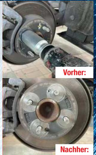
100.5090 Stehbolzen-Radnabenschleifer-Satz, Ø 50 / 60 mm
