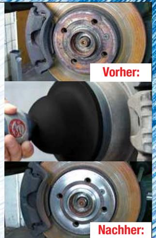
100.5080 Aluminium-Radnabenschleifer-Satz Ø 150 mm, Innen-Ø 90 mm
