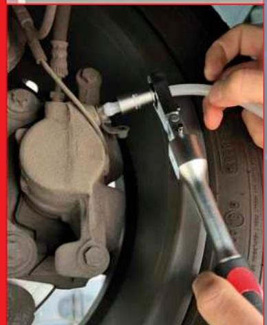
518.0320 Bremsen-Entlüftungs-Werkzeug-Satz für VAG
