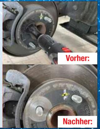
100.5085 Stehbolzen-Radnabenschleifer-Satz, Ø 40 mm
