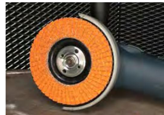
Enlèvement de copeaux maximal grâce à la densité élevée des lamelles.
