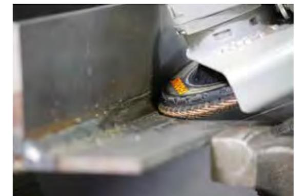
Support plastique ajustable pour une utilisation maximale des lamelles.
