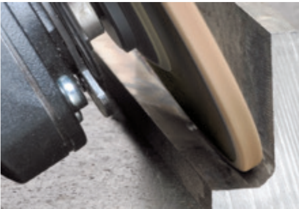
Langlebigkeit einer Schrupscheibe. Feines Schliffbild einer Fächerschleifscheibe
